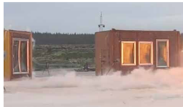
Сверху: управляемый взрыв Посередине: воздействие ударной волны на фасад Schüco Снизу: воздействие ударной волны на окна и двери Schüco Top: the controlled explosion Next: progress of the blast wave showing the Schueco façade deflecting Bottom: progress of the same blast wave showing its impact on Schueco windows and doors
