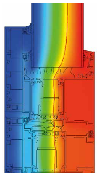
Прохождение изотерм Schüco ADS 112 IC Isothermal flow Schüco ADS 112 IC
