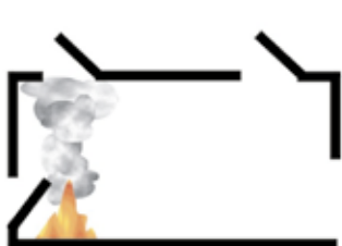
Здание с устройствами RWA A building with SHEVS
